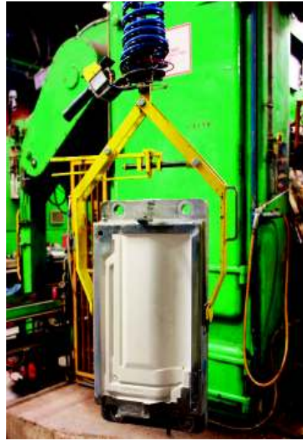
»2 Mould gripper with longer, angulated limbs »2 Formentransportzange mit verlängerten und gekröpften Aufnahmeschenkeln
